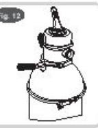
e. Fäst kontrollventilen vid den övre tanken och kontrollera att o-ingén sitter på plats på den övre tankens kant och att det vertikala röret på samlingenhetens huvud är sättat i kontrollventilens bas (Se Fig. 11).
