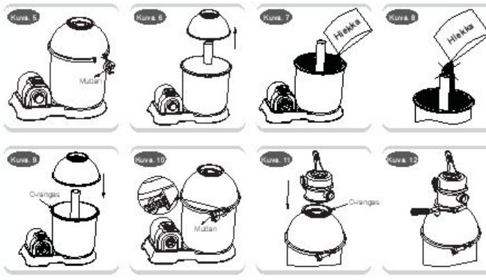
e. Litä saatöventtiili yläsäiliöön varmistaen, että O-rengas on paikallaan yläsäiliön reunaan ympärillä ja että kesiön pystysuora putki työntyy saatöventtiilin pohjaan (Katsa Kuva. 11).
