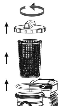
**ПРИМЕЧАНИЕ:** Защитный фильтр надо регулярно чистить. Грязный или забившийся защитный фильтр ухудшает работу песчаного фильтра.
